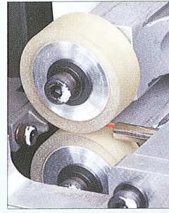
●特殊ローラ ウレタンゴムローラ 傷が付きやすい被覆、柔らかい被覆、極薄被覆などの電線に最適です。 粗目ローラ 滑りにくい被覆、堅い被覆などの電線に最適です。 細目ローラ 幅広い種類の電線に対応します。 (標準装備)
